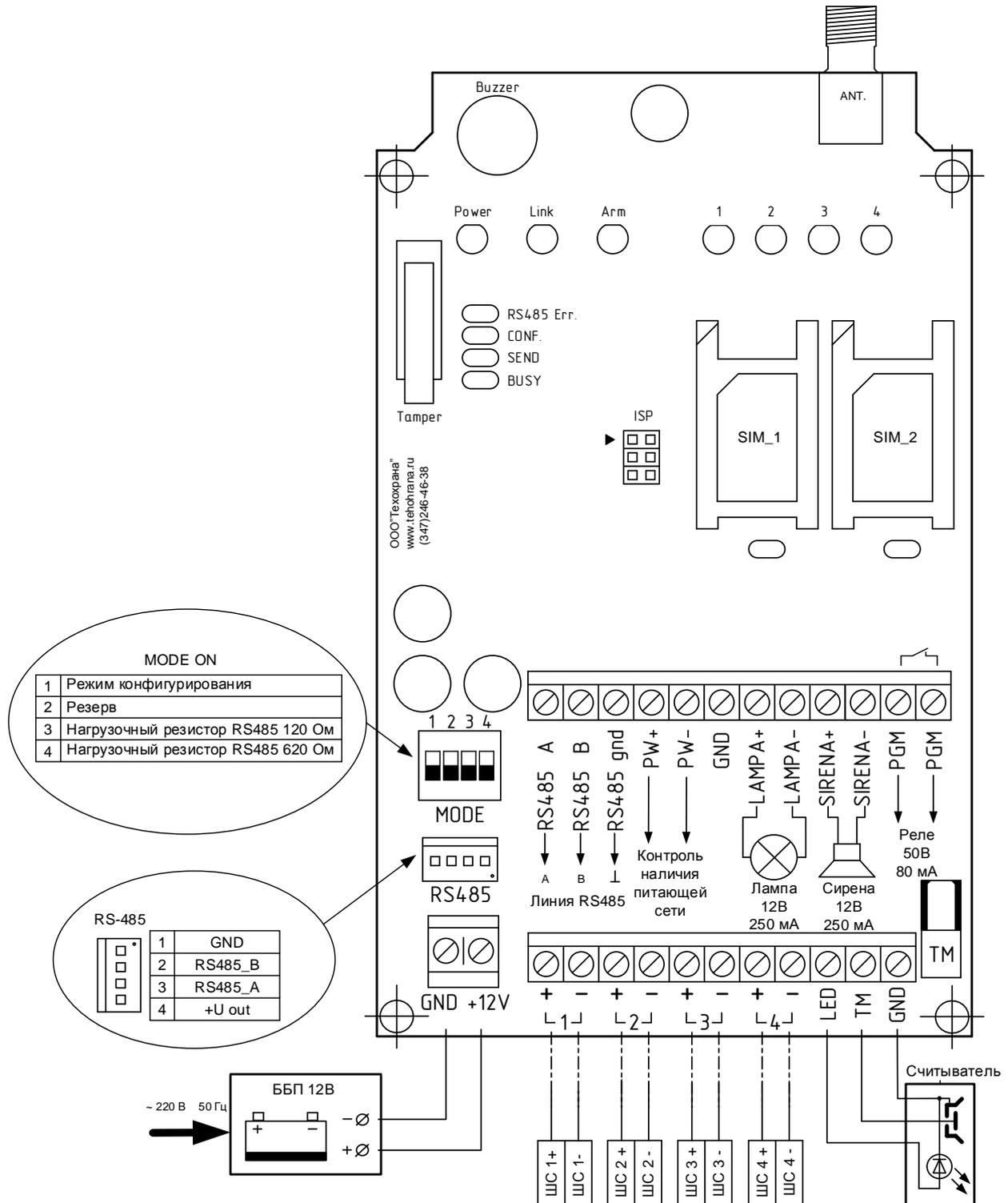
Рисунок 3. Схема подключения прибора.
