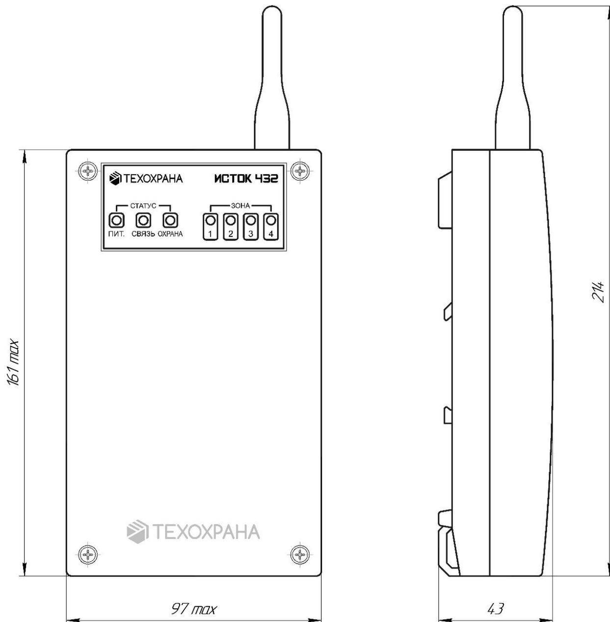
Рисунок 1. Габаритные размеры УОО «ИСТОК 432»
